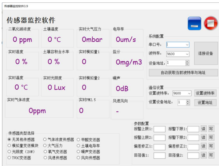
图 1-2 噪音与 PM2.5 传感器调试软件
