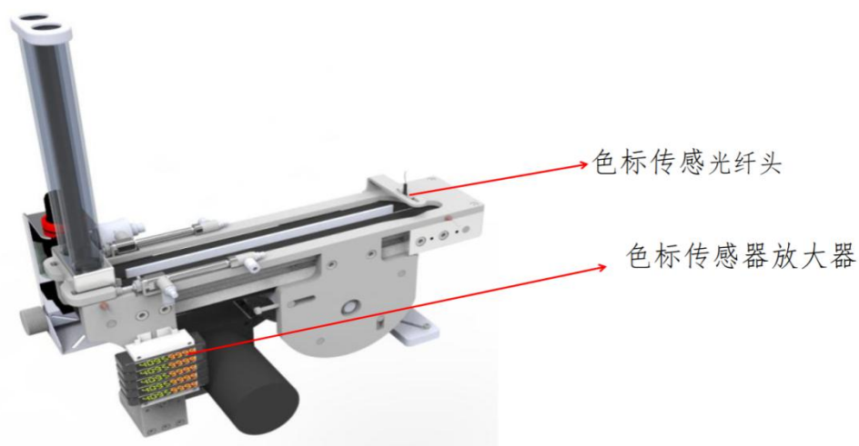
图 1-4 色标传感器安装位置效果图
